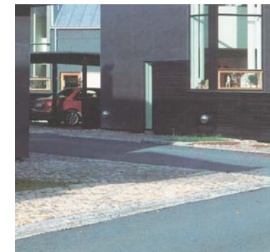
Skarpa men överkörningsbara hörn ger smala gator och låga hastigheter med bibehållen tillgänglighet.
