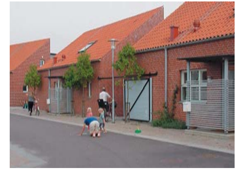
Förebild för bebyggelsen söder om östvästliga gator. Husen har fått en uppdelning i två volymer. En huvudvolym av tegel i 1,5 plan mot gatan och mot trädgårdssidan en tvåvåningsvolym av trä.
