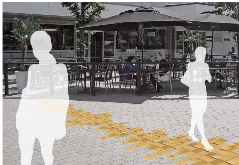
Fotomontage med infällt marktegel i betongplattor.
